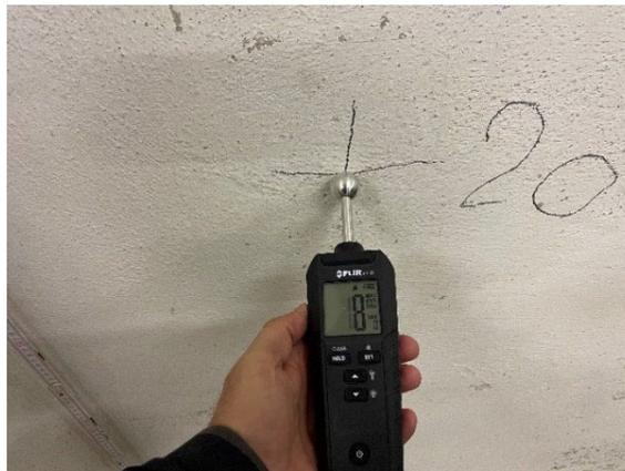
Bild 3: Entnahmestelle 2 oben, Feuchtemessung
